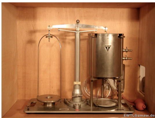
Abbildung 4-3: Feindruck-Prüfwaage für Kalibrierungszwecke (links), Fast-FID reagiert empfindlich auf sich verändernde Umgebungsbedingungen (rechts).
