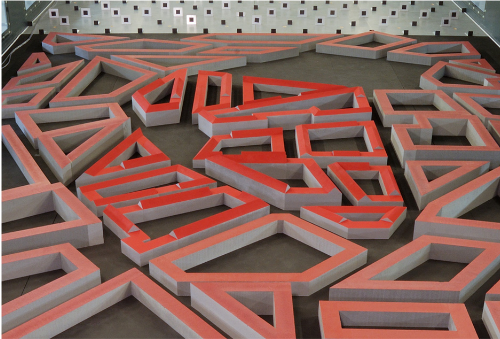
Abbildung 5-6: Modell der Michel-Stadt mit Spitzdächern (Konfiguration 2) im Windkanal der Universität Hamburg im Maßstab 1:225.
