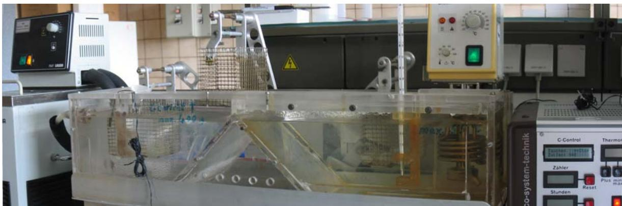
**Abbildung 11: Transportkorb während des Thermocyclings in den drei Positionen von links: 5 °C Bad, Überführung und 55 °C Bad**
