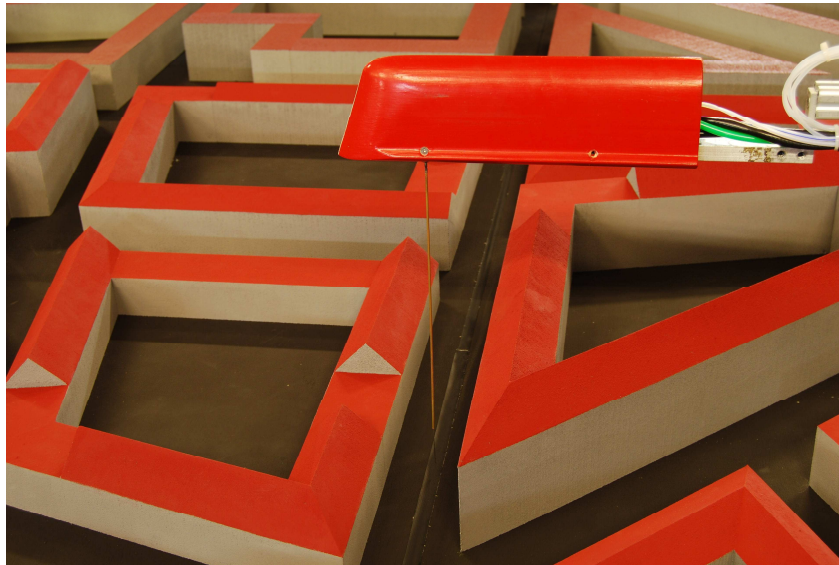
Abbildung 3.17 Fast-FID im Messbetrieb.
