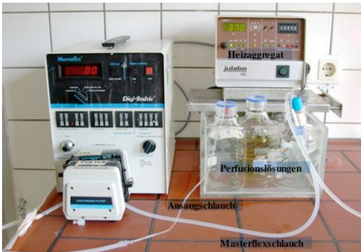
Abb. 4 zeigt das zusammengebaute Perfusionssystem
