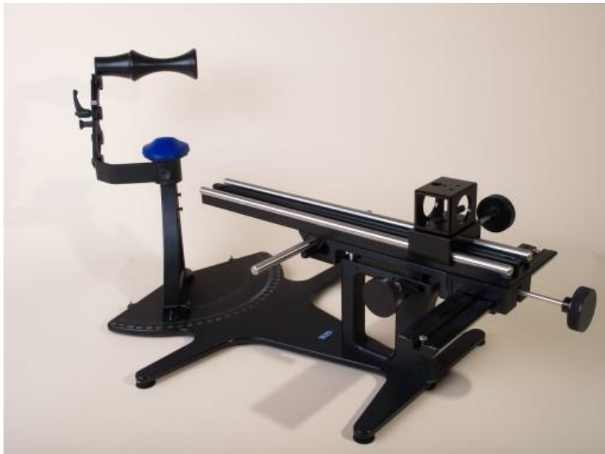
Abbildung 3.4 Kopfstativ mit einstellbaren Winkeln für die Messung mit dem PRIMOSlite. Quelle: GFMesstechnik 2011
