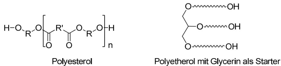
**Abb. 24: Verschiedene Polyolkomponenten.**
