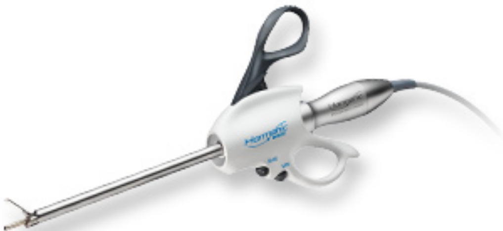
Abb. 3: Harmonic Wave® Ultraschalldissektionsgerät. Der Schaft ist 18 cm lang und hat einen Durchmesser von 8,5 mm. Die Klinge ist 18 mm lang. Mit dem Gerät können Gefäße bis 5 mm Durchmesser verschlossen werden (Ethicon Endo Surgery, 2011)
