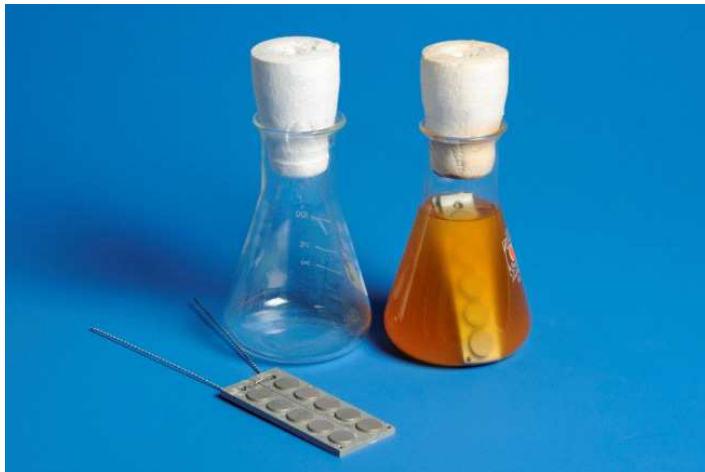
Abb. 13: Titan-Plättchen auf Trägern, Flaschen mit Bakteriensuspension und Nährbouillon
