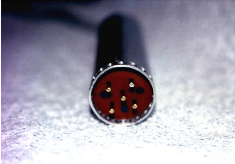
Abb.41: Meßsonde des Meßverfahrens zur Bestimmung der Hautfeuchtigkeit (MEF). Die Meßsonde hat einen Durchmesser von 25 mm und besteht aus 5 gefederten Elektroden, die ein kreisförmiges Hautareal erfassen. Die fünf Signale werden zu einem Signal gemittelt.
