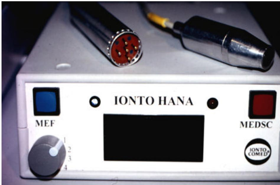
Abb.40: IONTO HANA (Firma Ionto Comed in Eggenstein); Meßsystem zur Messung der Hornschichtdicke (roter Wahlschalter) und der Hautfeuchtigkeit (blauer Wahlschalter mit Meßbereichswahlstufen 1 - 4).
