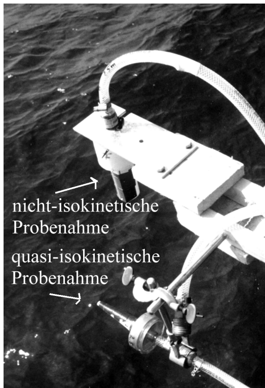
Abb. 5-1: Quasi-isokinetische und nicht-isokinetische Probenahme auf Östergarnsholm (GOT 1996) in 7.7 m Höhe über dem Meeresspiegel.
