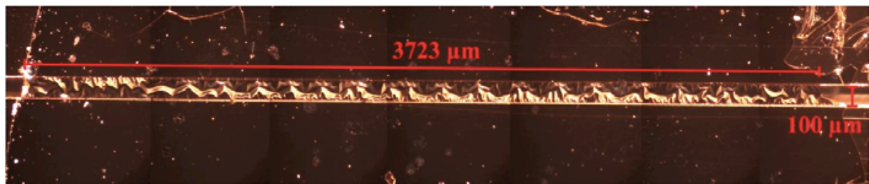
Abbildung 60: Lichtmikroskopische Aufnahme eines freistehenden Gold-Nanopartikel Schichtsystems über einem 100µm breiten Graben in der Gold-Elektrodenstruktur über die gesamte Länge 3723 µm. Aus [29] mit freundlicher Genehmigung von IOP Publishing Ltd. 2011.
