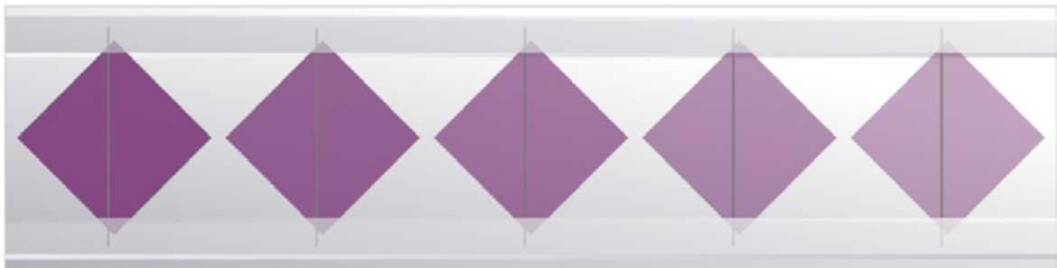
Abbildung 82: Schematische Darstellung der Maskierung der Substrate zur Elektroden-Aufdampfung: Über den festgeklebten Substraten (lila) wird zentral je eine Kanüle mithilfe von Klebefilm befestigt.
