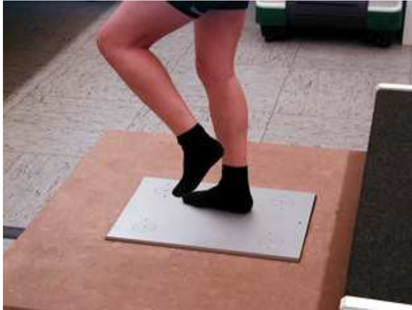
Abbildung 5: Kistler-Messplattform mit Holzrahmenkonstruktion
