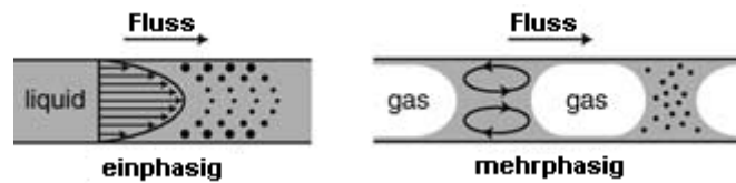
Abb. 79: Einphasen- und Mehrphasenströmung im Mikrokanal [83]
