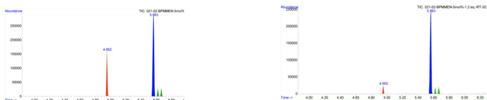
Chromatogramm 1 – Umsatz nach 30 min bei 0 °C mit Kat. [Fe(BPM MEN)](SbF<sub>6</sub>)<sub>2</sub> [11-5] Chromatogramm 2 – Umsatz nach 30 min bei RT mit Kat. [Fe(BPM MEN)](SbF<sub>6</sub>)<sub>2</sub> [11-5]
