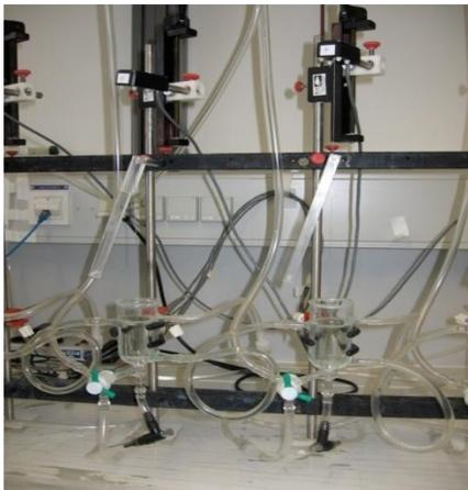
Abb.11: Bild einer Organbadkammer.
