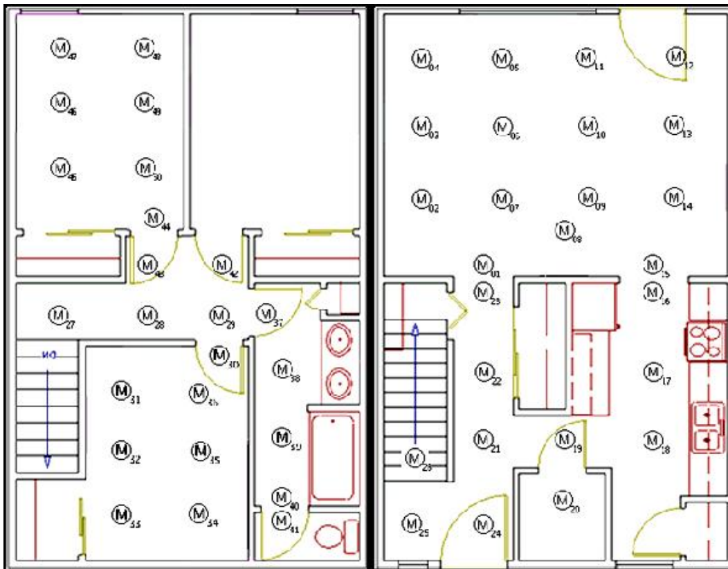
Abbildung 56: Sensorenkarte der experimentellen Wohnumgebung des Projekts CASAS (aus [87]).
