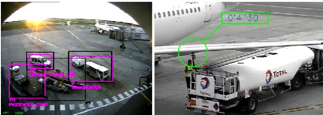
Abbildung 46: Links: Bild einer festen Kamera mit detektierten Objekten. Rechts: Bild einer PTZ-Kamera mit detektiertem Objekt (aus [50], [96]).
