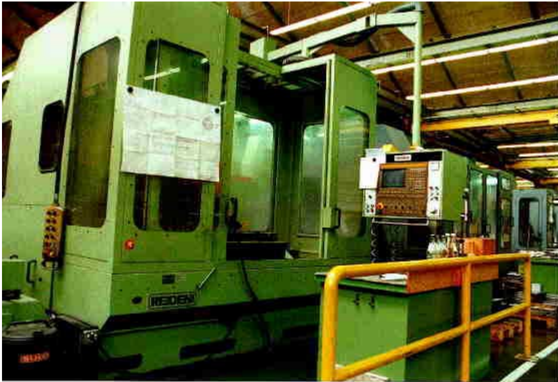
Abbildung 1: CNC-Fräsmaschine mit schwenkbarer Steuerung
