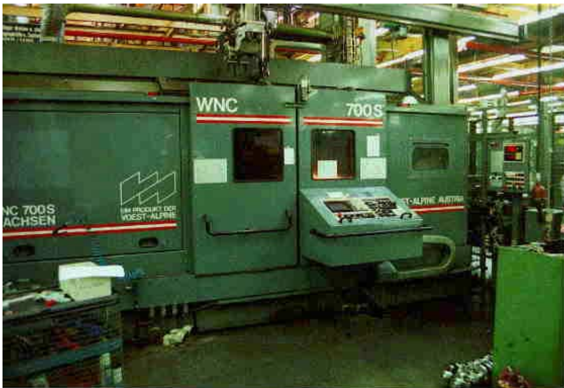
Abbildung 3: CNC-Drehmaschine mit statischer Steuerung
