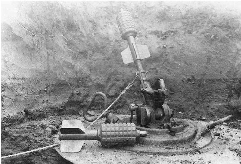
Abb. A1.96.: Granatenwerfer 15 mit Wurfgranaten 15,
