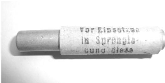
Abb. 3.20.: Deutsche Sprengkapsel Nr. 8, in Transporthülle, Länge 45 mm,  $\varnothing$  7 mm
