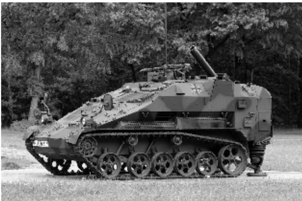
Abb. 7.8.: Wiesel 2 mit 120 mm Mörser,
