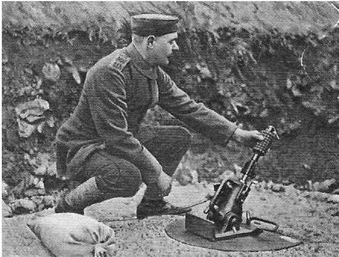
Abb. A1.98.: Granatenwerfer 16 mit Wurfgranate 15, man beachte den Sandsack als Rücklaufbegrenzung, Quelle: Sammelbild, nach einem Foto des Reichsarchivs
