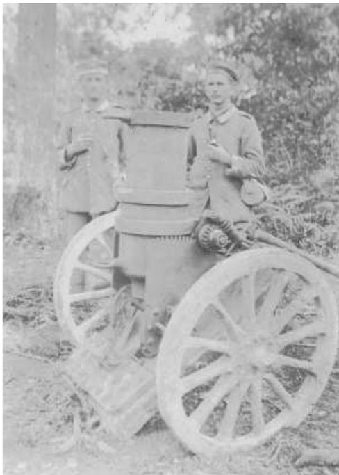
Abb. 6.5.: Richteinrichtung eines Voith-Minenwerfers, mit den Elementen Schnecke, Zahnrad und Zahnkranz, Quelle: Archiv des Verfassers ©
