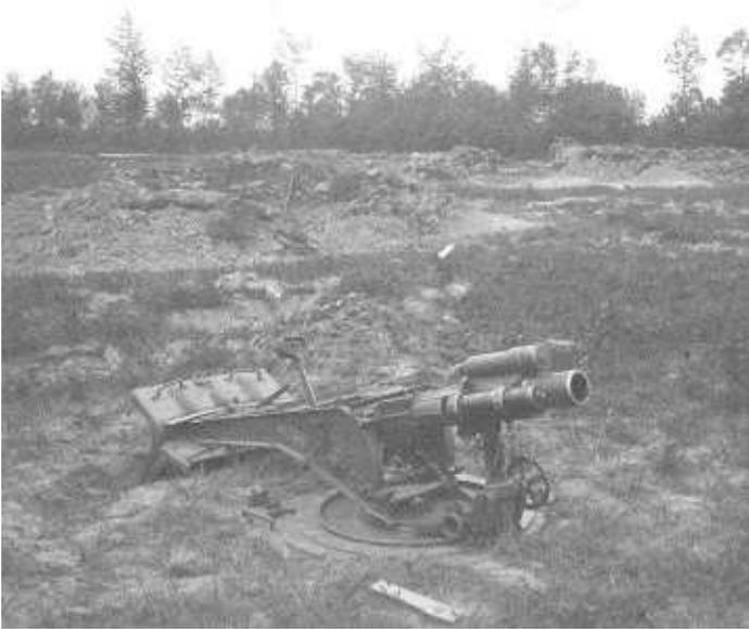
Abb. A1.28.: 7,585 cm leichter Minenwerfer n.A. in Flachbahnlafette, man beachte den für den Sporn ausgehobenen Ringgraben, Quelle: Archiv des Verfassers ©
