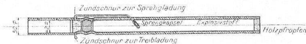
Abb. A4.5.: Sprengmine des Lanciatorpedini Bettica (Schnitt),
