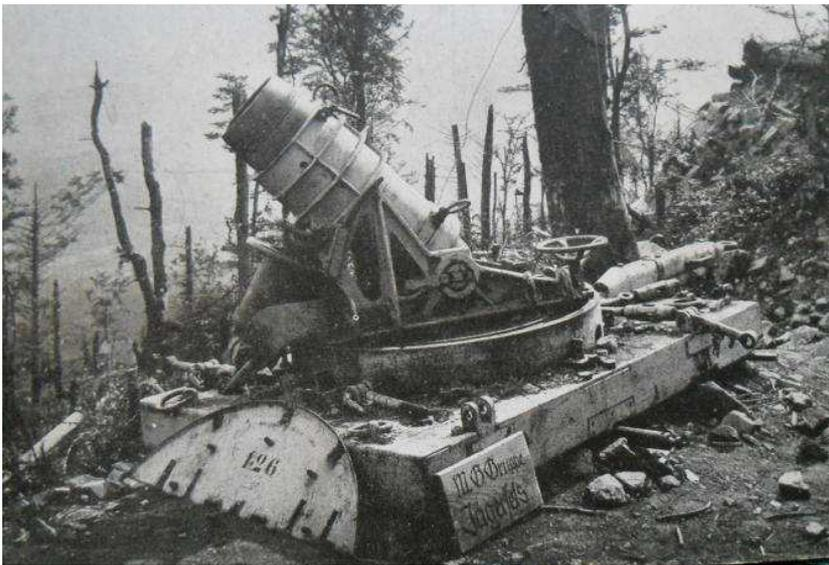
Abb. A1.80.: 24 cm schwerer Flügelminenwerfer Albrecht ohne Rohr, Hartmannsweilerkopf, französische Bildpostkarte, Quelle: Archiv des Verfassers ©
