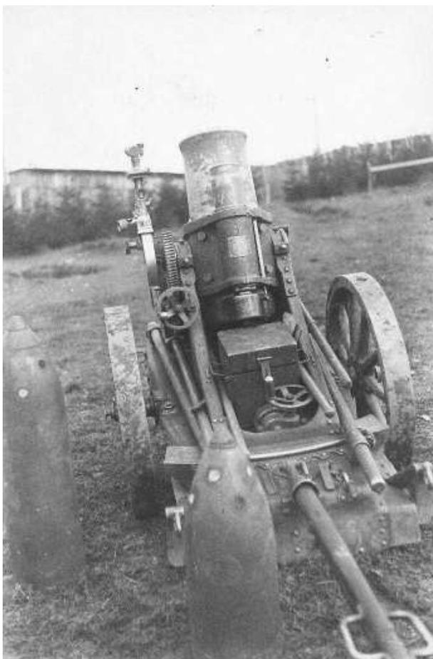
Abb. A1.4.: schwerer Minenwerfer a.A. mit zwei Gasminen, erkennbar an den Gasaustrittsöffnungen am Kopf, hinten 1/1 ganze Mine, vorn 1/2 halbe Mine, Quelle: Archiv des Verfassers ©
