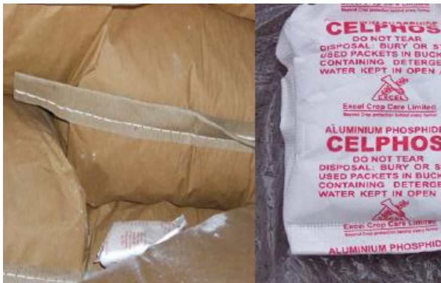
Abbildung 1.2: Phosphidpräparat zwischen Waren in einem Container
