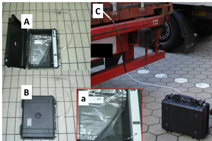
Abbildung 6.1: A: Ein Probenbeutel wird in die Probenahmepumpe eingelegt und über einen Schlauch im Inneren der Pumpe (besser sichtbar in Bildabschnitt a) mit einer hohlen Lanze verbunden. B: Pumpe geschlossen. C: Probenahme am Container.
