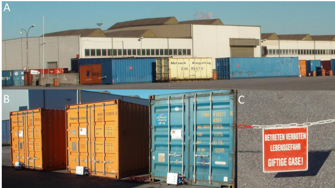
Abbildung 7.1: Begasungsplatz A: Begasungsplatz mit Absperrung durch leere Container und Absperrketten, B: Container auf dem Begasungsplatz unter Begasung, C: Hinweisschild an der Abgrenzung des Begasungsplatzes.
