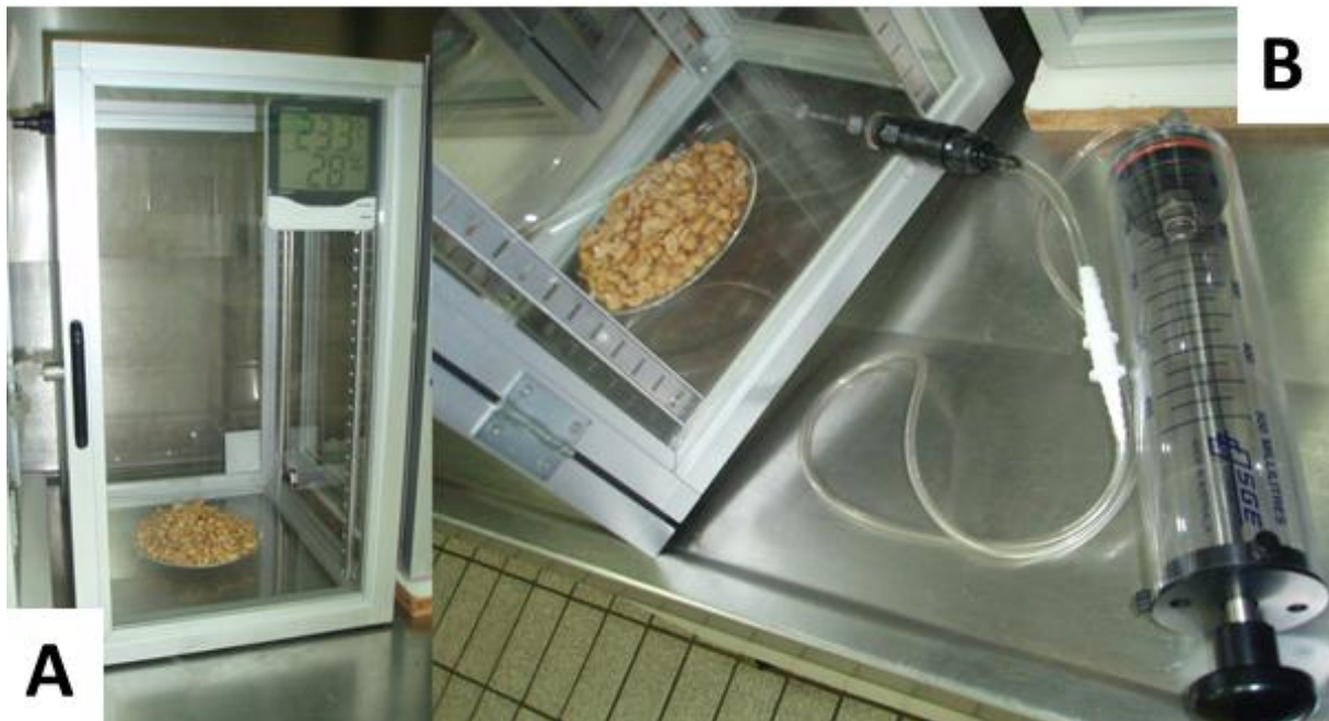
Abbildung 8.2: A: Erdnüsse in der Probenkammer. B: Entnahme von Luft.
