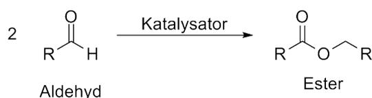
Abbildung 3.1 Darstellung von Estern mittels der Tishchenko-Reaktion.
