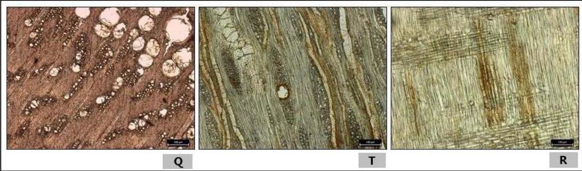
Abbildung 5-27. Mikroskopischer Schnitt von Pistacia als Vergleichsprobe
