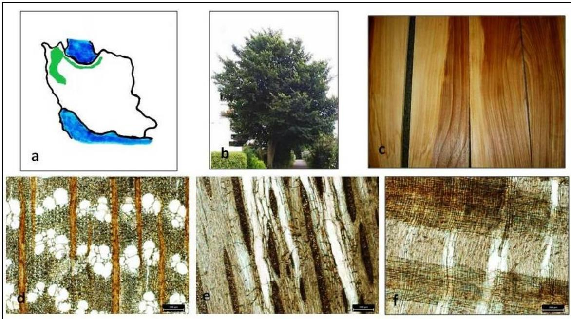
Abbildung 6-27. a: Verbreitung von *Ulmus* im Iran, b: *Ulmus*-Baum, c: Makroskopische Holzansicht, d: Q-Schnitt, e: T-Schnitt, f: R-Schnitt.
