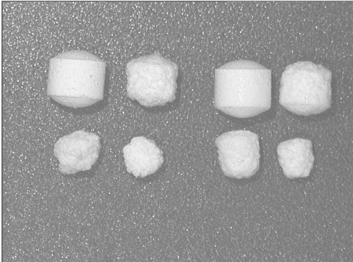
Abb. 23: 2 mm Minitabletten, links  $D_{rel,max} = 0.80$ , rechts  $D_{rel,max} = 0.96$ .
