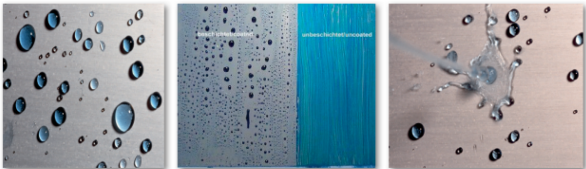
Abb. 8: Darstellung ETC-Effekt: Material beschichtet versus unbeschichtet. (Abbildung mit freundlicher Genehmigung durch Dr. Uwe Wienhold, Chemiker, Fa. Wienhold-Consult, Magdeburg)
