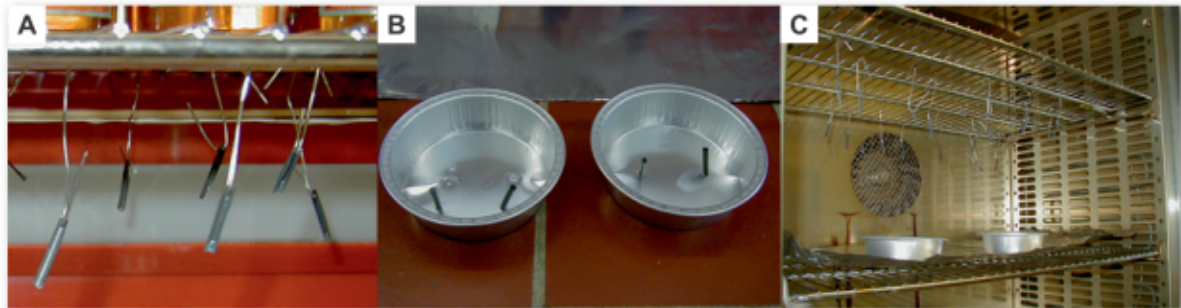
Abb. 12: Stentproben im Trocknungsverfahren A: Halbrunde Prothese: Abtropfen des Überstandes der Stentbeschichtung. B: Runde Prothese: Trocknung der Stentbeschichtung in der Aluminiumschale. C: Trocknung der Stentbeschichtung im Trockenschrank bei 90°C.
