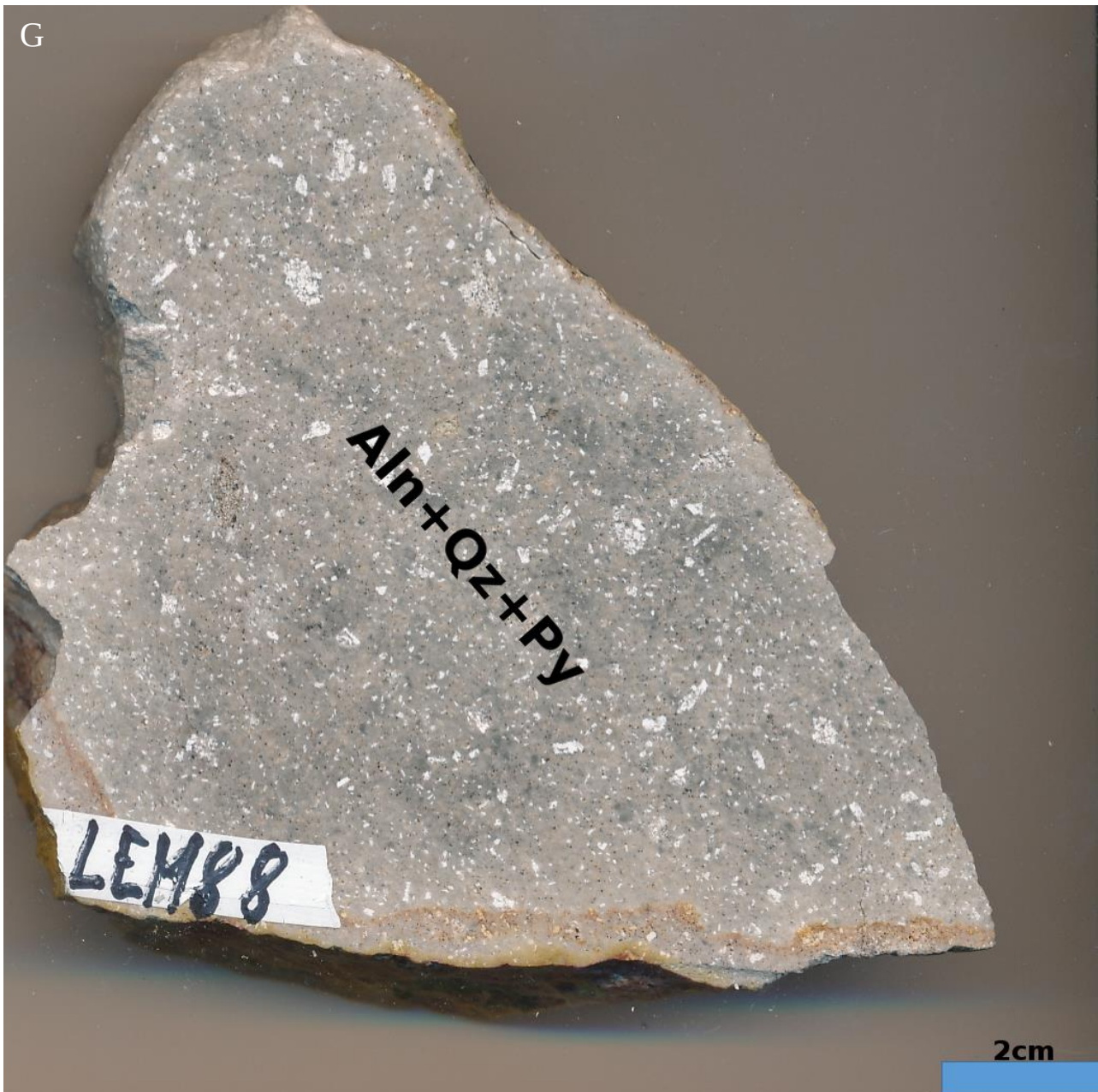
Abb. 30 Repräsentative Handstücke verschiedener hydrothormaler Gesteinsalterationen der Region Fakos mit A) - „potassic“ alterierten trachyandesitischen mafischen Dikes, B) - Quarz-„sericitic“-Turmalin alterierten ehemaligen Monzonit, C) - „calcic-potassic“ alterierter Monzonit, D) - „calcic-potassic“ alterierter trachyandesitischer mafischer Dike, E) - „calcic±sodic/potassic“ alterierter trachyandesitischer mafischer Dike, F) – „calcic-sodic“ alterierte trachyandesitische mafische Dikes und G) „advanced argillic“ alterierter ehemaliger Sandstein mit Aln (Alunit, Qz (Quarz) und Py (Pyrit).
