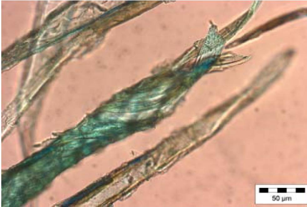
Abb. 6.42: Aufnahme eines beschädigten Altholzfaserendes (Vergrößerung 40-fach, Färbung: May-Grünwald)
