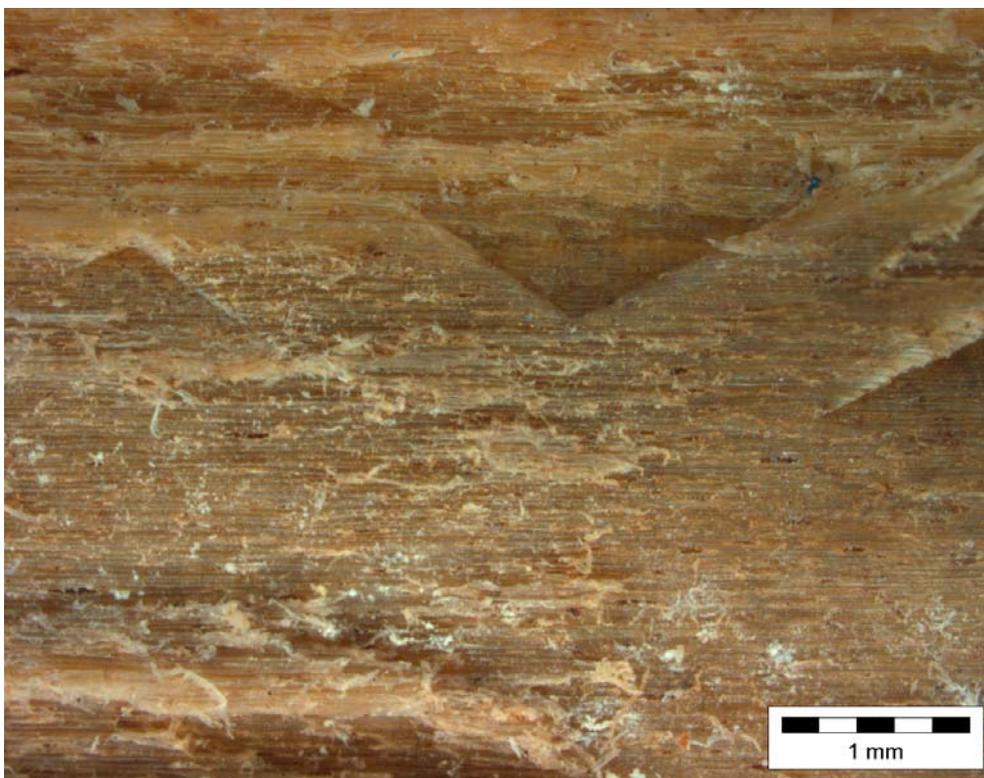
**Abb. 6.19: Stauchung an einer Altholzoberfläche, verursacht durch ein Verpackungsstahlband
