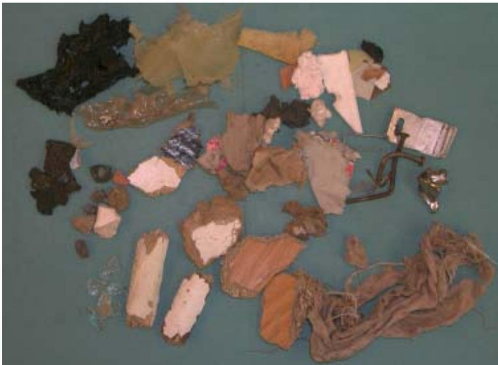
**Abb. 6.4: Typische Störstoffe einer Altholzcharge**
