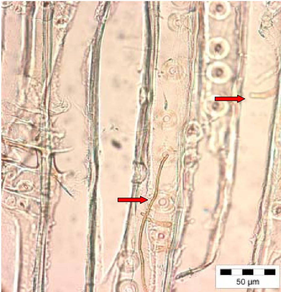
Abb. 6.31: Anhäufungen von Bläuehyphen in den Tracheiden eines Hackspans (Tangentialschnitt, Vergrößerung 40-fach, Durchlicht, Polfilter)
