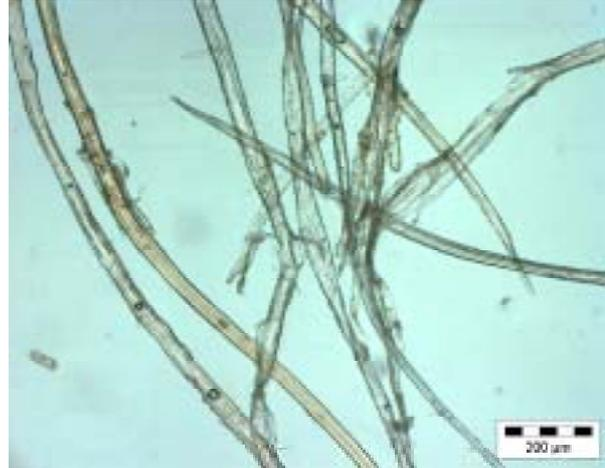
**Abb. 6.29:** Altholzfaserstoff, gewonnen bei 180°C mit einer Vordämpfzeit von 5 min; Aufnahme einer repräsentativen Probe (Vergrößerung 10-fach, Färbung: Jod-Jodkalium)
