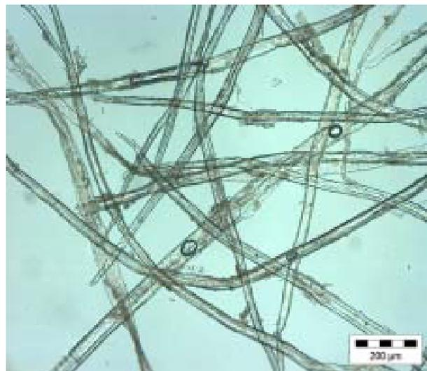
**Abb. 6.23:** Kiefernfaserstoff, gewonnen bei 150°C mit einer Vordämpfzeit von 5 min; Aufnahme einer repräsentativen Probe (Vergrößerung 10-fach, Färbung: Jod-Jodkalium)
