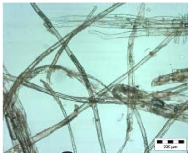
Abb. 6.27: Altholzfaserstoff, gewonnen bei 150°C mit einer Vordämpfzeit von 5 min; Aufnahme einer repräsentativen Probe (Vergrößerung 10-fach, Färbung: Jod-Jodkalium)
