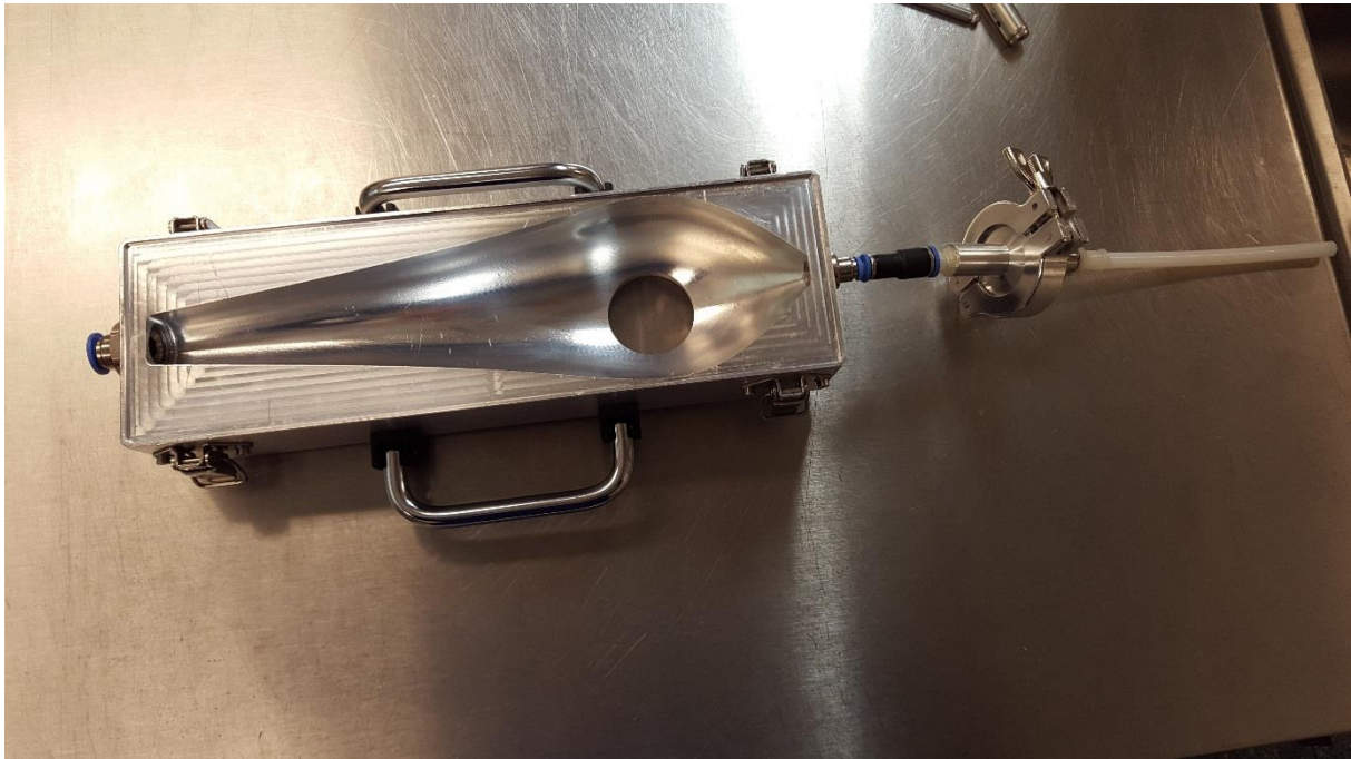
Abbildung 2: Kammeraufsatz mit der Auffangvorrichtung für das Filterpapier.
