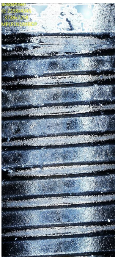
Abb. 16: Implantatausschnitt nach Bearbeitung mit Karbonkürette vestibuläre Fläche
