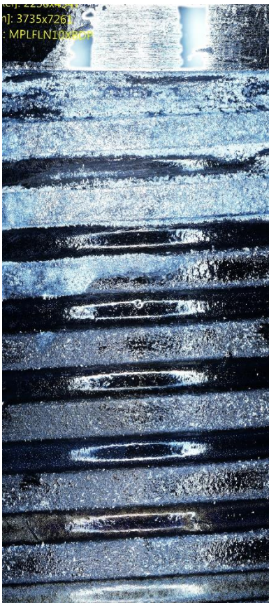
Abb. 25: Implantatausschnitt nach Bearbeitung mit PEEK-Spitze vestibuläre Fläche
