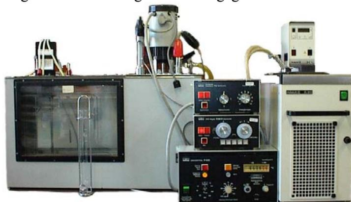
Abbildung 135: Viskosimetrieanlage.
