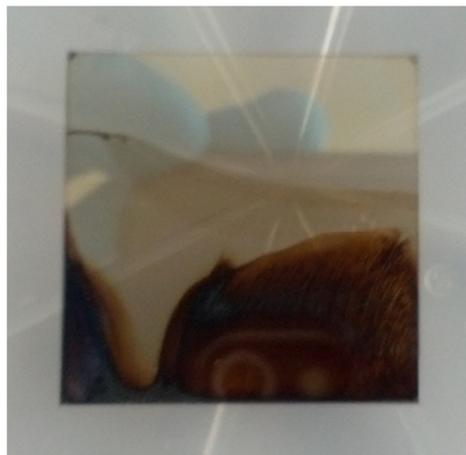
**Abbildung 3.27:** Abbildung eines mit ITO beschichteten Glaträgers auf dessen Oberfläche mithilfe der elektrochemischen Abscheidung ein PbS-Nanopartikelfilm aufgebracht wurde.
