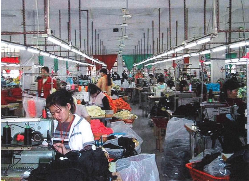
Abb.33: Mangelnde Fluchtwegkennzeichnung und versperrte Rettungswege (Privataufnahme mit freundlicher Genehmigung von Esther Tse, 2009)
