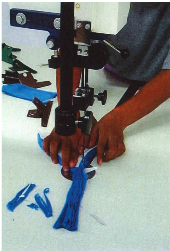
Abb.26: Hohes Unfallrisiko beim Zuschnitt ohne Metall-Schutzhandschuh (Privataufnahme mit freundlicher Genehmigung von Esther Tse, 2009) 606
