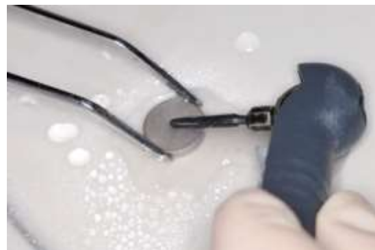
Abb. 19: Reinigung eines Versuchsplättchens
