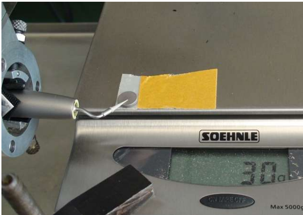
Abb. 13: Einstellung des Anpressdrucks
