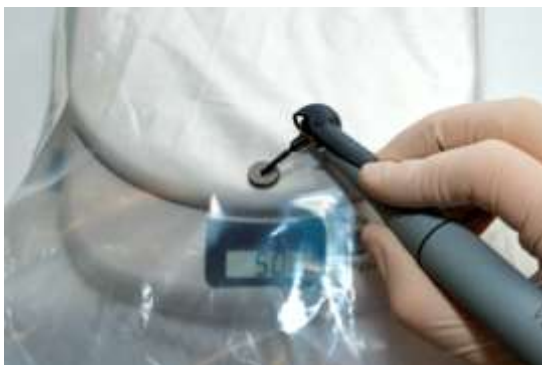
Abb. 18: Kontrolle des Anpressdruckes mittels Waage
