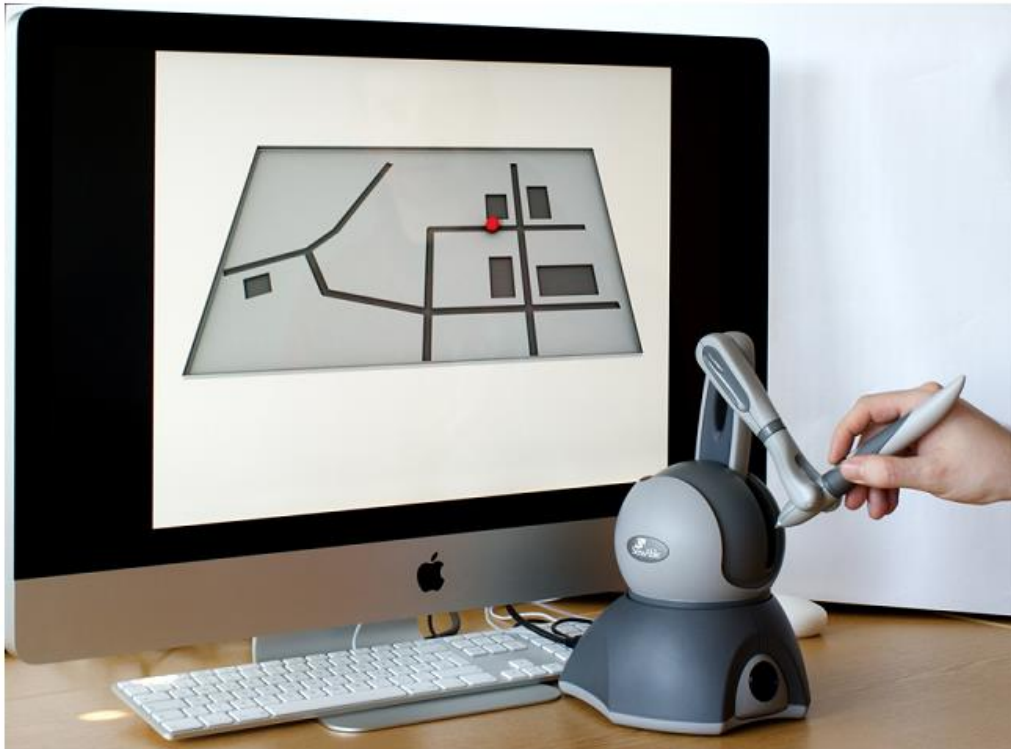
Abbildung 1.1: Visualisierung einer linien-basierten Graphik (Straßenkarte) in einer virtuellen haptischen Umgebung und ein haptisches Force-Feedback-Gerät (Phantom Omni).
