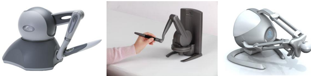
Abbildung 3.5: Haptische Ein-/Ausgabegeräte: (von links nach rechts) Phantom Omni 4 , Phantom Desktop 5 und Novint Falcon 6 .
