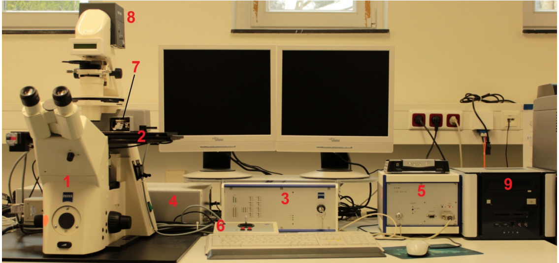
Abbildung 2-2: Aufbau des PALM® MicroBeam Systems. 1: inverses Mikroskop; 2: RoboStage; 3: zentrale Steuereinheit; 4: Festkörperlaser; 5: Steuereinheit des Lasers; 6: Joystick zur Steuerung des CapMovers; 7: CapMover; 8: Kamera; 9: Rechner zur Steuerung des Systems.
