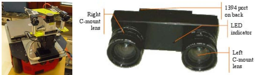
Abbildung 2.4.: Zwei in der vorliegenden Arbeit eingesetzte Stereokamerasysteme. Auf der linken Seite ein eigen entworfenes 3-D-Wahrnehmungssystem. Das Stereokamerasystem besteht aus zwei Sony XC-999P-Kameras mit VCL-06S12XM-Objektiven und einer ca. 15 cm Basislinie, montiert auf einem Pioneer 2-DX-Roboter der ActiveMedia Robotics. Auf der rechten Seite ein weiteres Stereokamerasystem, STH-MDCS mit 9 cm Basislinie von Videre Design.
