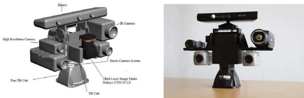
Abbildung 2.17.: Entwurf und einer der ersten Realisierungsversuche eines Active Perception Stereo Head.
