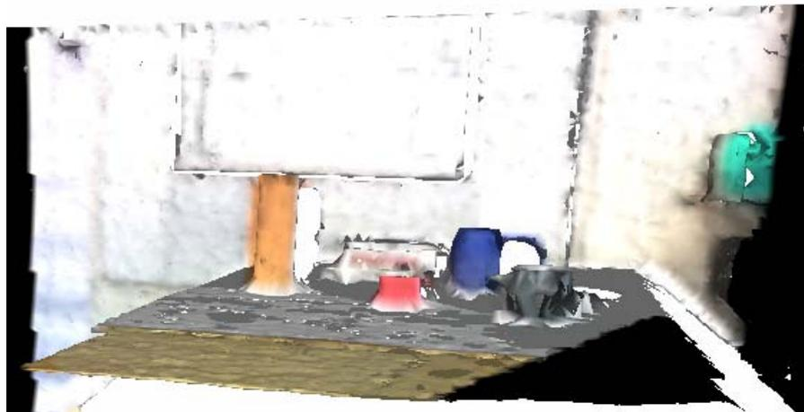
Abbildung 3.9.: Die Ergebnisse der 3-D-Rekonstruktion mit dem Ball-Pivoting-Algorithmus inklusive des Interpretationsschrittes. Nur der fusionierte Bereich ist sichtbar.
