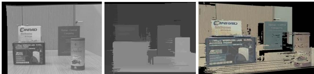
Abbildung 2.5.: Gewinnung der Tiefeninformation mit einem Stereokamerasystem. Von links nach rechts: rektifiziertes Image der rechten Kamera, Disparitätsbild erstellt unter Zuhilfenahme des Birchfield-Algorithmus, Rekonstruktion.
