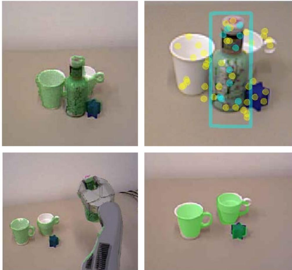
Abbildung 6.15.: Auflösung der Verdeckung durch einen aktiven Eingriff in die Szene. Nach der Manipulation wird die Szene erneut analysiert. Nach der erneuten Analyse sind alle Objekte richtig erkannt worden.
