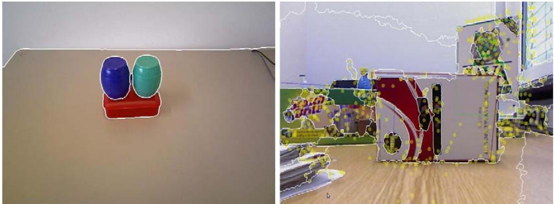
Abbildung 4.2.: Zwei Beispiele der Farbsegmentierung mit einem der bekanntesten Farbsegmentierungsalgorithmen JSEG. Links dargestellt eine einfache Szene mit klaren Farbübergängen und optimal erzielten Segmentierungsergebnissen. Rechts abgebildet eine komplexere Szene mit vielen ineinandergreifenden Texturen und kaum weiter verwendbaren Ergebnissen.
