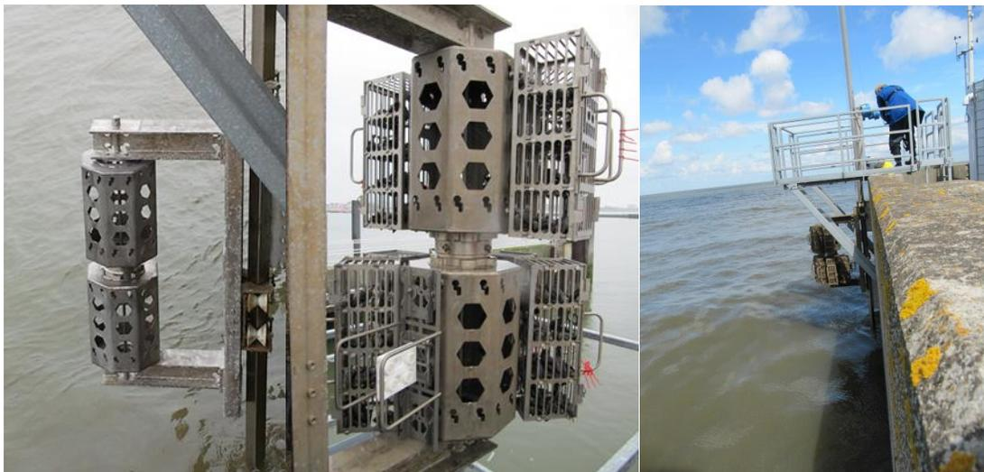
**Abbildung 32:** Probenstation Cuxhaven „Seebäderbrücke“, rechtes Bild Grundgerüst der Station doppelte Trommel, mittleres Bild (Quelle: J. Gandraß, Helmholtz-Zentrum Geesthacht)
