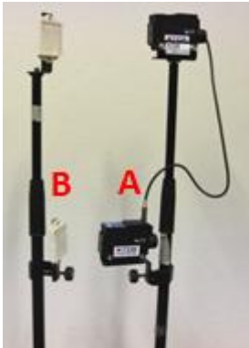
Abb. 10: Doppellichtschranke (A) mit Reflektor (B) Firma Werthner Sport Consulting KG (Linz/Österreich)
