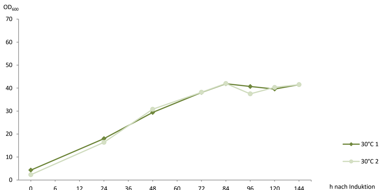
Abb. 105: Entwicklung der optischen Dichte zweier Kulturen in gepufferten Minimalmedium. Es zeigten sich minimal geringere Kulturdichten am Ende der Fermentation verglichen mit Kulturen in Komplexmedium. Die Signifikanz dieser Abweichungen wurde nicht genauer untersucht, da auch in diesen Experimenten keine Peroxidaseaktivitäten in den Zellüberständen nachweisen ließen. Gezeigt sind die Verläufe zweier angezogener Kulturen. Das Wachstum der Kulturen. Dargestellt ist das arithmetische Mittel aus n= 3 unabhängigen Versuchen mit entsprechender Standardabweichung.
