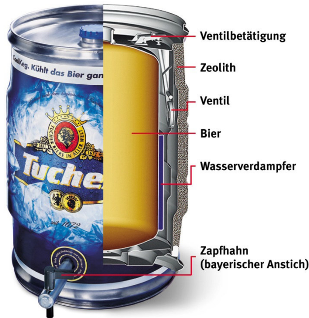
Abbildung 2: Selbstkühlendes Bierfass. Durch Betätigung des Ventils wird eine Verbindung zwischen dem mit Wasser getränkten Vlies (Wasserverdampfer) und dem Zeolith in der äußeren Wand des Bierfasses hergestellt. Der Zeolith adsorbiert Wasserdampf aus dem Vlies, die benötigte Verdampfungswärme wird dem Bier entzogen, so dass dieses nach ca. 30 min eine Temperatur von 7 - 9 °C erreicht. [16]
