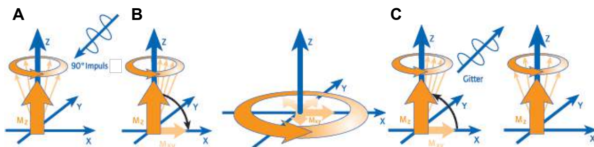
Abb. 6: Hochfrequenzimpuls (A), Induktion von M_{xy} (B) und Relaxation (C)
