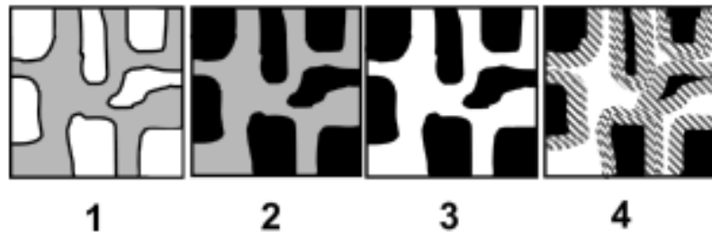
Abbildung 1.35. Schema der Synthese von einem porösen Kohlenstoffmonolithen und des korrespondierenden Komposits aus Kohlenstoff und \text{LiFePO}_4 . Schritt eins ist die Herstellung eines meso-/makroporösen Silicamonolithen. Dessen Poren werden mit der Kohlenstoffvorstufe gefüllt und carbonisiert (Schritt 2). Nach dem chemischen Entfernen des Silica (Schritt 3) folgt die Imprägnation mit der LFP-Vorstufe und die Reduktion zum \text{LiFePO}_4 (Schritt 4). (131) Copyright ACS.
