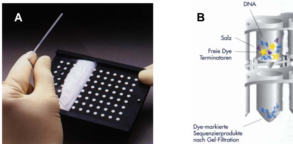
Abb. 2.9 Für das gleichmäßige Aufladen des Sephadex-Pulvers in eine 96-well-Platte wird der MultiScreen Column Loader verwendet (A). Die so entstandenen Mini-Säulen reinigen die Farbstoff-markierten Sequenzierungsprodukte mittels Gel-Filtration auf (B), (aus dem Anleitungsheft des Herstellers).
