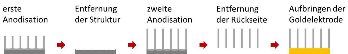
Abbildung 3.13: Templatherstellung mit zwei Anodisierungsschritten
