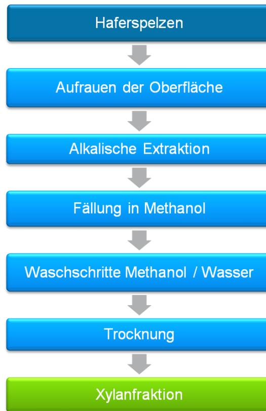
**Abbildung 13** Prozessschritte zur alkalischen Extraktion von Xylanen aus Haferspelzen
