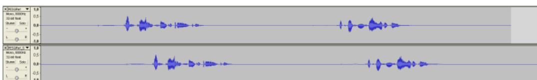
Abb. 12.11: Referenzsignal und zu Beginn zeitlich verschobenes Testsignal für den PESQ-Algorithmus [117]
