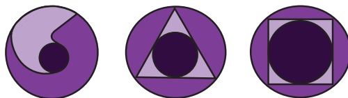
Abb. 10: Kern bei einer Hedström-Feile (links), Reamer oder K-Feile mit dreieckigem Querschnitt (Mitte) und Reamer oder K-Feile mit quadratischem Querschnitt (rechts)
