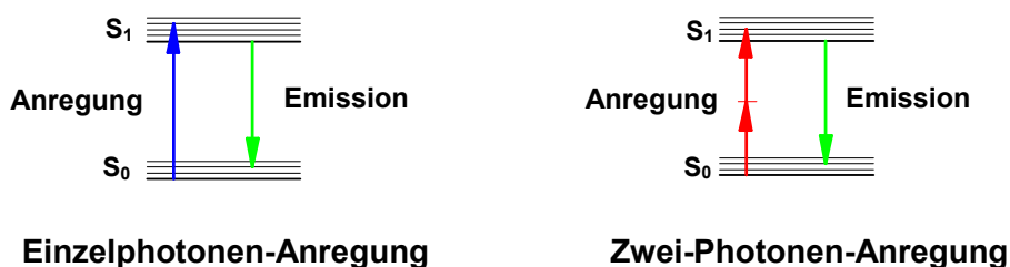
Abbildung 3.5: Jablonski-Diagramme. Energieniveaus eines Fluorophors bei Einzelphotonen-Anregung (links) und Zwei-Photonen-Anregung (rechts). Die Farben der Pfeile entsprechen den absorbierten und emittierten Wellenlängen. S_0 , energetischer Grundzustand des Fluorophors, S_1 , angeregter Zustand des Fluorophors.
