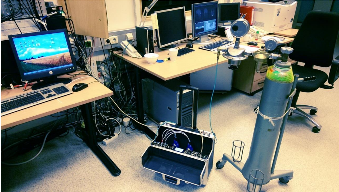
Abbildung 4 – Der Versuchsaufbau außerhalb des Magnetbereichs: Stimulus-PC neben Olfaktometer und angeschlossener Druckluftflasche.
