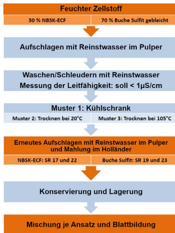
Abb. 17: Faserstoffmischung und Vorbehandlung in Anlehnung an Brecht und Lindström (Brecht und Erfurt 1959b; Lindström 1980)
