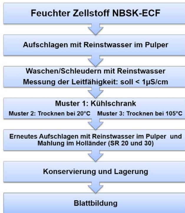
Abb. 16: Faserstoffvorbereitung in Anlehnung an Brecht und Lindström (Brecht und Erfurt 1959b; Lindström 1980)
