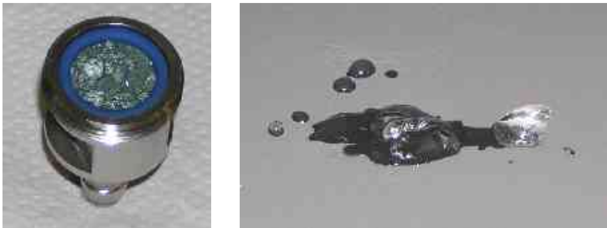
Abbildung 4.5.1-3 Aufnahmen vom Gelanteils der Probe CMC 11 zum einen auf dem 11 \mu m Filter und zum anderen als Rückstand bei der Zentrifugation
