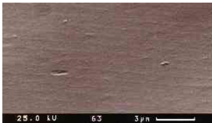
Abbildung 6.1-3 REM Aufnahmen der verwendeten Celluloseregeneratfaser-membran. Oberfläche
