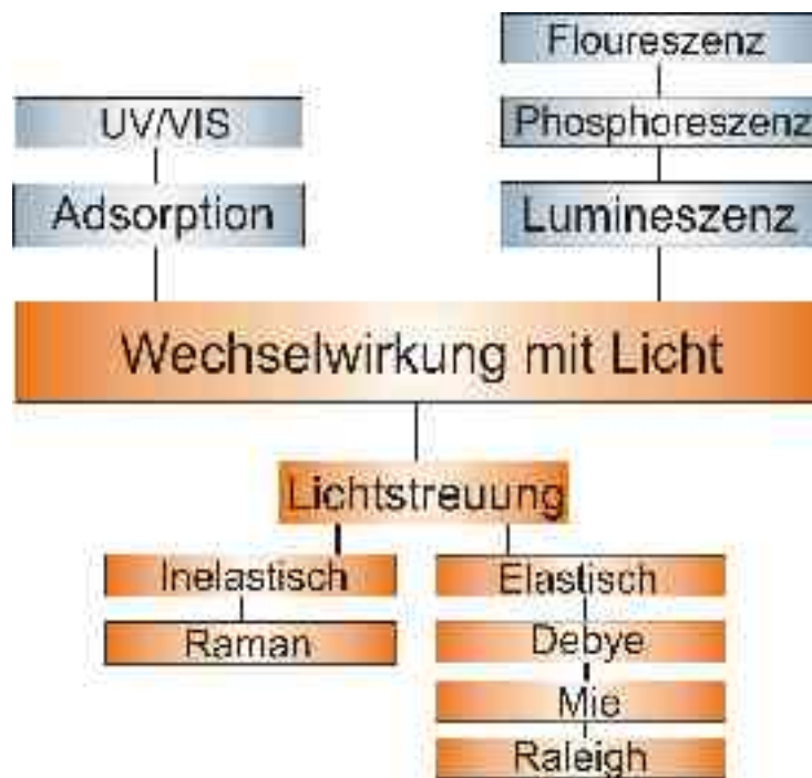
Abbildung 2.3-1 Schematische Darstellung der Wechselwirkungsformen von Licht mit Materie
