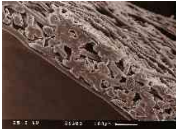
Abbildung 6.1-4 REM Aufnahmen der verwendeten Celluloseregeneratfaser-Membran. Trennschnitt durch die Membran (Oberfläche unten links im Bild)
