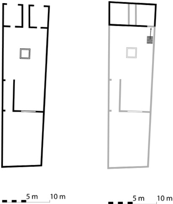
Abb. 15: Grundrisse Erdgeschoss und Obergeschoss in der 1. Bauphase
